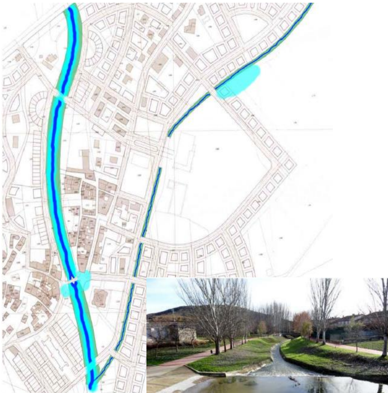
Figura 6. Trazado del río Irantzu y de la regata Regüeta posterior al encauzamiento de los mismos en 1992 en las inmediaciones de Villatuerta. En azul claro zonas de inundación conocidas. Foto del canal de hormigón de forma trapezoidal desde el puente románico.
