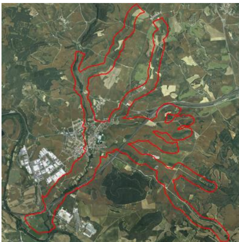
Figura 43. Ortofoto de 25 cm de 2017, superponiendo la zona 2D del estudio hidráulico en rojo.
