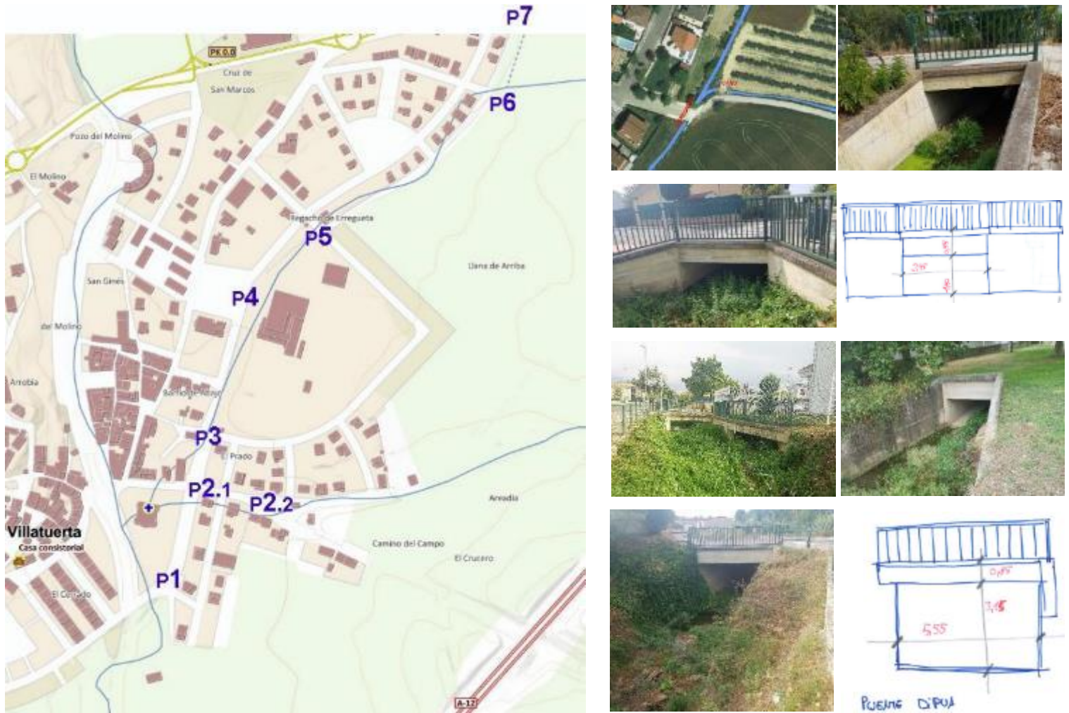
Figura 9. Obras de fábrica de la margen izquierda medidas por el Ayto. Villatuerta y modelizadas por Tracasa.
