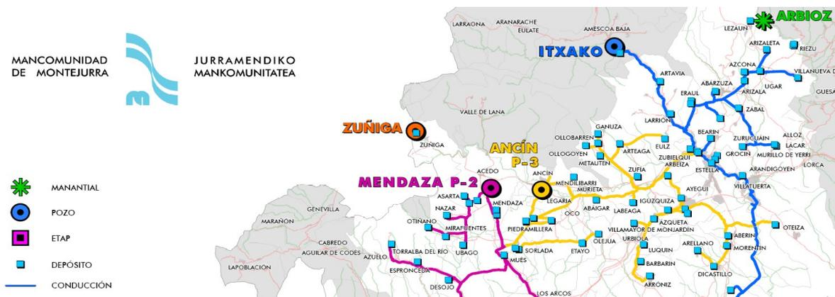
El agua se distribuye a través de depósitos en alta hasta el depósito de la localidad situado al norte del núcleo, situado a la cota 478 m. Desde allí se abastece por gravedad a los puntos de consumo, con conducciones de FD  $\varnothing 200$  mm de salida desde el depósito hacia el núcleo residencial y FD  $\varnothing 250$  mm de salida desde el depósito hacia el polígono industrial - Estella.
